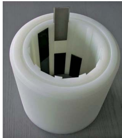
Abb. 4 Biofilm-Reaktoren mit entnehmbaren Aufwuchsflächen (links: Einzelmodul mit einer herausgeschobenen Testfläche, rechts: Anlage mit fünf Säulen à fünf Module).
