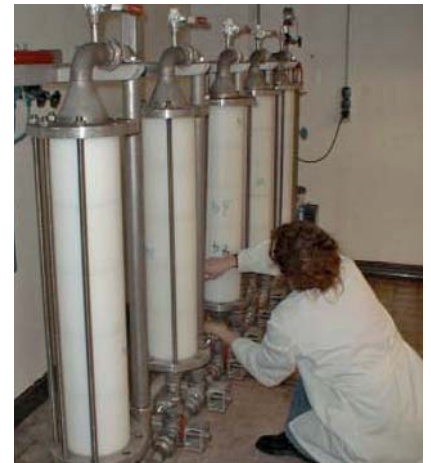
Abb. 4 Biofilm-Reaktoren mit entnehmbaren Aufwuchsflächen (links: Einzelmodul mit einer herausgeschobenen Testfläche, rechts: Anlage mit fünf Säulen à fünf Module).
