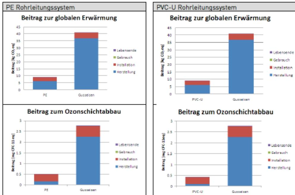
Fig. 2: Beiträge in den Kategorien „globale Erwärmung“ und „Ozonschichtabbau“ für das PE und das PVC-U Rohrleitungssystem. CO<sub>2</sub>-eq = Kohlendioxid-Äquivalente, CFC-11eq = Trichlorofluormethan-Äquivalente.
