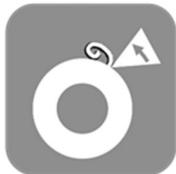
Der Schälbereich für den Anschluss-Sattel ist auf dem Rohr zu markieren. Das Rohr ist im Schweißbereich lückenlos zu schälén. Dabei ist auf eine konstante Spannbildung ( $\geq 0.2\text{mm}$ ) beim Rotationschälgerät zu achten. Da die Schälmesser einem Verschleiss unterliegen, ist ein regelmässiger Unterhalt notwendig und im Zweifelsfall sind die Schälmesser auszutauschen.
