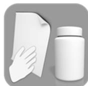
Schweissflächen auf dem Rohr und am Sattel müssen sauber, trocken und fettfrei sein. Auf dem Rohr wird nur im geschälten Bereich gereinigt.
