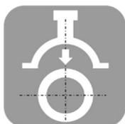
Die Sattelposition wird auf dem Rohr markiert. Ohne die Schweissflächen zu berühren - Sattel entsprechend Herstellerangaben aufs Rohr montieren und Sitz kontrollieren (Spalt).
